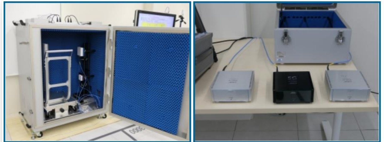
シールドボックスを使えば、開発中の5G機器の動作確認などが行える（左）。サブ6GHz帯に対応する5Gの基地局と端末の仮想環境もある（右）。中央の黒い機器が基地局、両脇の機器が端末になる
